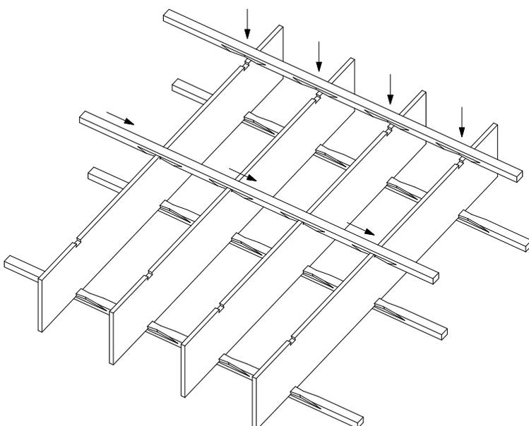
6. Insérer les montants suivants dans les encoches des plateaux. Les glisser ensuite dans l'assemblage pour les mettre en place.
