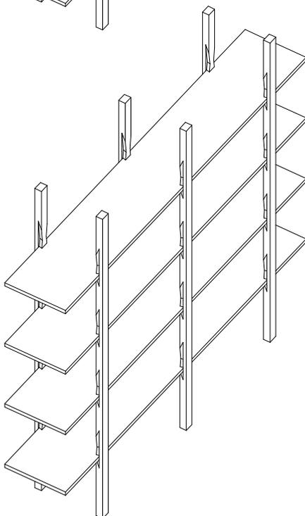
10. Si certains assemblages ne plaquent pas correctement, frapper sur le devant du montant pour fermer l'espace puis reverrouiller l'assemblage en frappant sur le plateau.
