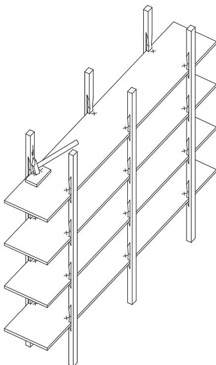
9. Frapper avec précaution sur les plateaux à l'aide d'un marteau et d'une cale au niveau de chaque assemblage pour les verrouiller et stabiliser l'ensemble.
