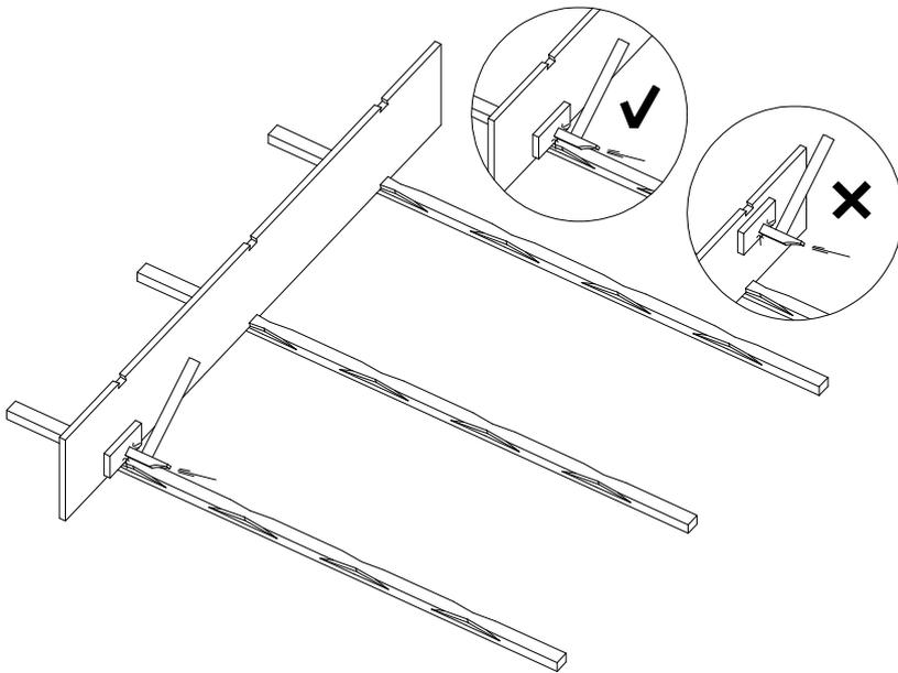
4. A l'aide d'un marteau et d'une cale, frapper délicatement le plateau au niveau des montants pour verrouiller les assemblages. Attention à frapper près de l'assemblage pour ne pas endommager le plateau.
